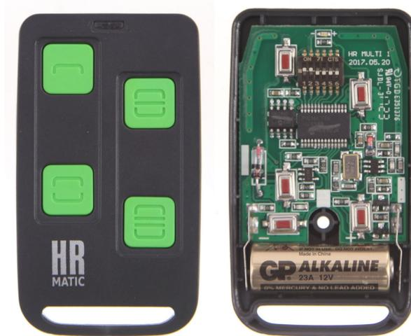
2.- Mettez les commutateurs DIP dans la position en fonction du modèle de commande que nous avons.
