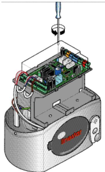
Sélectionner les fonctions, en mettant les microinterrupteurs sur ON ou OFF à l'aide d'un tournevis, comme indiqué sur la figure. Les microinterrupteurs 7 et 8 sont d'origine sur "ON".
