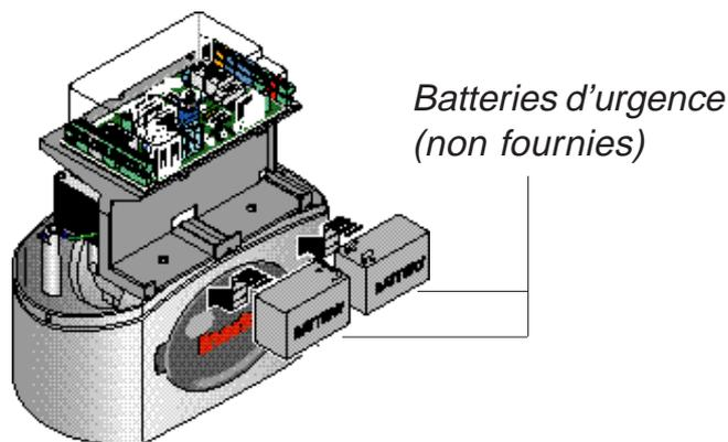
• Brancher le pôle positif (+) de la batterie n° 1 à la borne + de la carte de commande, le pôle négatif (-) de la batterie n° 2 à la borne - et brancher les deux pôles restants (+,-) entre eux (voir figure).
