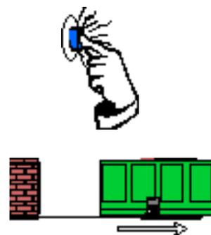
**Bouton pour «Commandes»** contact N.O., pour l'ouverture et la fermeture du portail (voir microinterrupteur n° 2) ou **fermeture durant le fonctionnement contact maintenu**, fermeture du portail en laissant constamment le bouton enfoncé ou la clé tournée (micro-interrupteur n° 6 sur ON).
