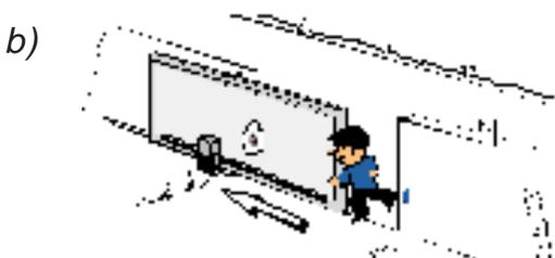
**8 OFF** Arrêt partiel; placer les photocellules (voir dispositifs de sécurité). Arrêt du portail en ouverture et en fermeture avec par conséquent préparation à la fermeture automatique si elle est activée (mettre le microinterrupteur sur ON si le dispositif n'est pas utilisé);
