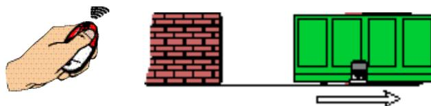
**4 ON** "Pré-clignotement en ouverture et de fermeture; après une commande d'ouverture ou de fermeture, le clignotant branché sur 20-K1, clignote pendant 5 secondes avant de commencer la manoeuvre;
