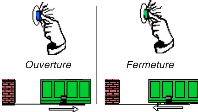
**7 OFF** Réouverture durant la phase de fermeture; placer les photocellules (voir dispositifs de sécurité). En détectant un obstacle durant la phase de fermeture du portail, les photocellules provoquent l'inversion de marche jusqu'à l'ouverture complète (mettre le microinterrupteur sur ON si le dispositif n'est pas utilisé);
