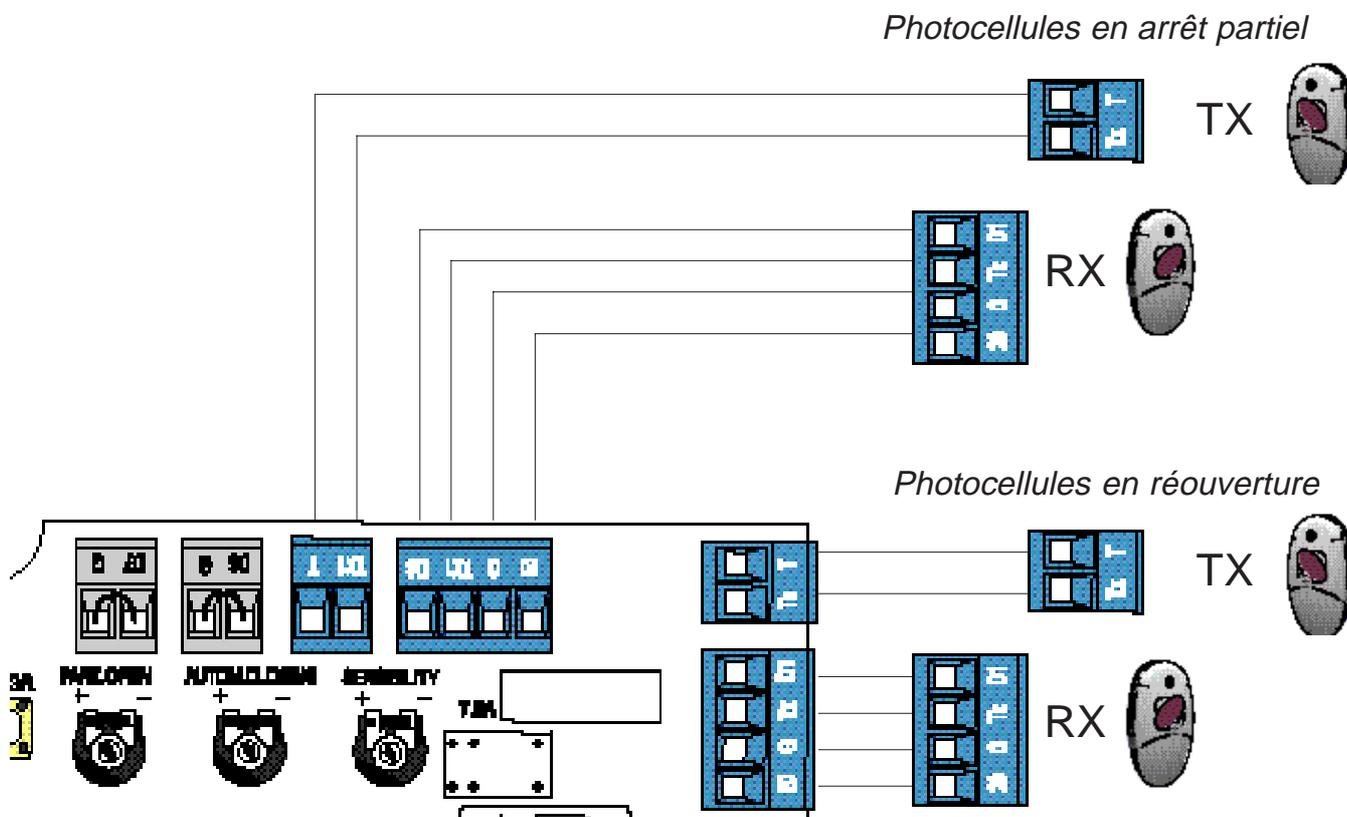
Branchement d'une paire de photocellules en **réouverture** et d'une photocellule en **arrêt partiel**, avec branchement éventuel d'un dispositif de sécurité en **réouverture** durant la fermeture du portail et d'un autre en **refermeture** durant l'ouverture.
