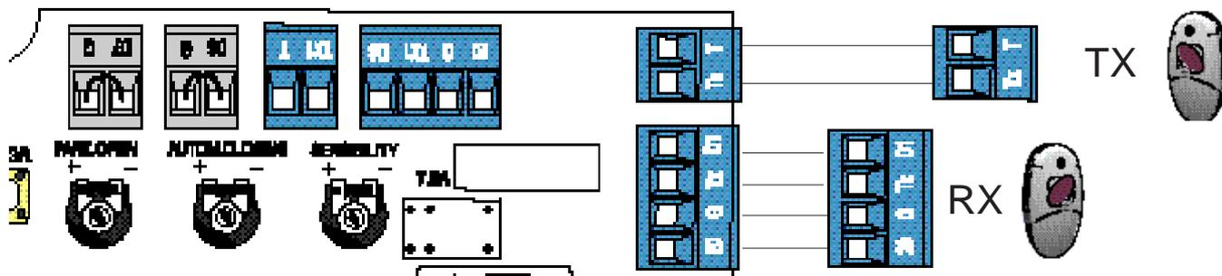
Branchement d'une paire de photocellules en **réouverture** durant la phase de fermeture et d'une photocellule en **arrêt partiel** (microinterrupteurs n° 7 et n° 8 sur OFF).
