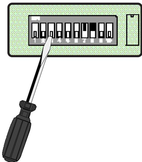
**1 ON** Fermeture automatique. Le temporisateur de fermeture automatique est auto alimenté à la fin du temps de la course en ouverture. Le temps réglable est programmé, cependant, il est subordonné à l'intervention d'éventuels accessoires de sécurité et il est exclu après une intervention de "stop" ou en cas de coupure de courant;
