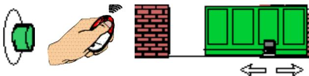
**3 ON** "Seulement ouverture" avec radiocommande (carte radio insérée);
