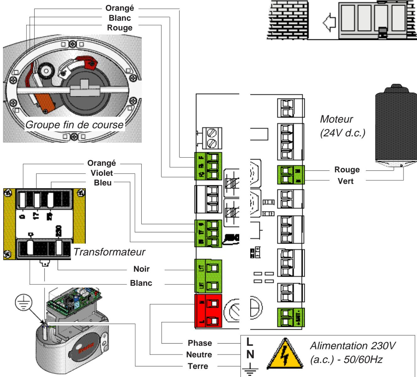
Pour le montage éventuel à gauche, inverser les fils électriques du microinterrupteur de fin de course FA-FC et les phases du moteur M-N.
