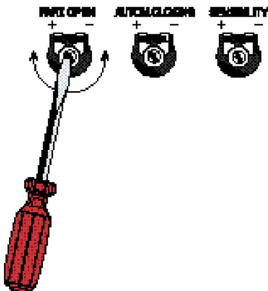
**Trimmer PART. OPEN** = Ouverture partielle. Il règle l'ouverture du portail pour le passage des piétons.
