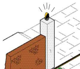
**5 ON** Dispositif de détection de présence avec moteur en fin de course; quand le moteur est arrêté (portail fermé, ouvert ou semi-ouvert, cette position est obtenue avec une commande de stop total), toute fonction de l'émetteur ou du bouton-poussoir est annulée en cas d'obstacle détecté par les dispositifs de sécurité (ex. Photocellules);
