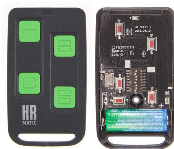
2.- Réglez le commutateur DIP dans la position correcte, en fonction de l'émetteur à main d'origine.
